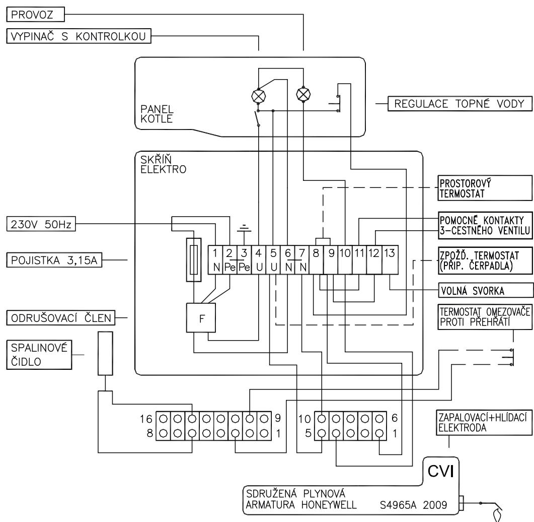
PŘIPOJENÍ ČERPADLA PŘES ZPOŽĎOVACÍ TERMOSTAT
